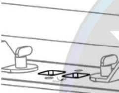
Se suministran dos soportes de cuarto de vuelta con el dispositivo si se va a colgar por encima del suelo.
